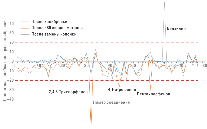
Рис. 16. Проверки калибровки после начальной калибровки, после 680 вводов матрицы и после замены колонки.
